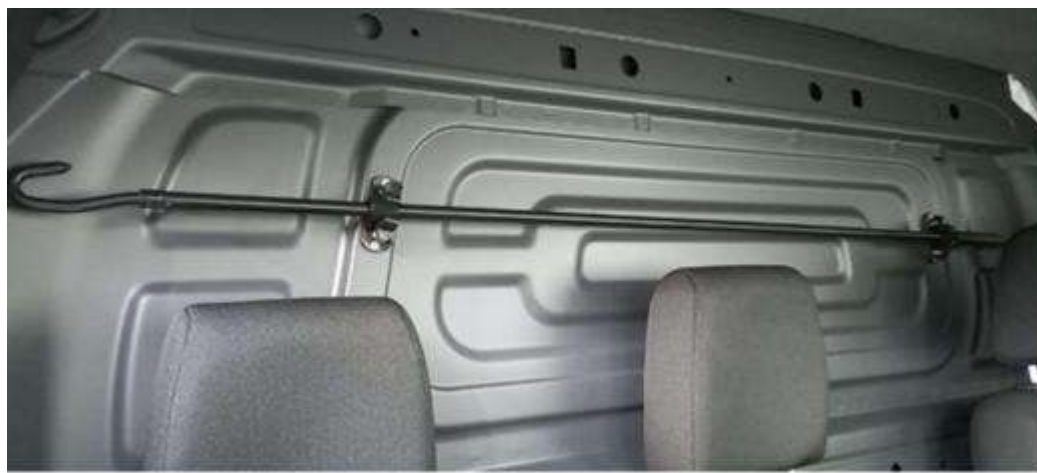
Figura 22: Gancho do toldo fixado na parte superior do banco do motorista
